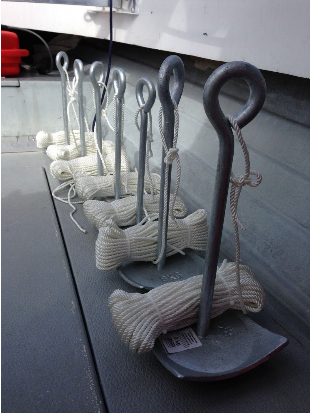
Foto 2. Ankare för uppmärkning av positioner för specialmärken
