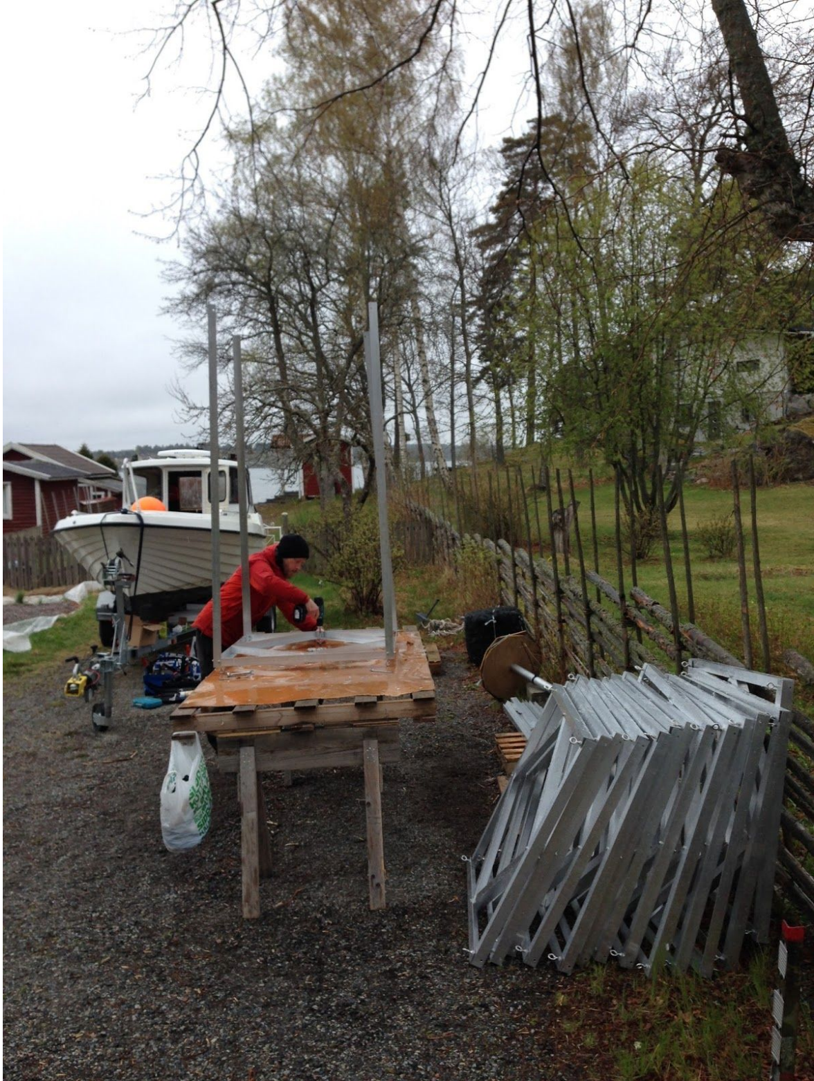
Foto 10. Tillverkning av testriggar "burrigar"
