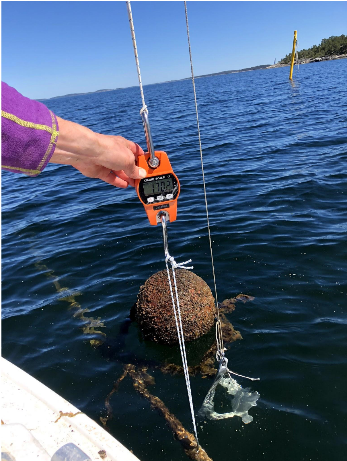
Foto 6. Invägning av "stora" prototypodlingen inför korrigerig av flytkraft
